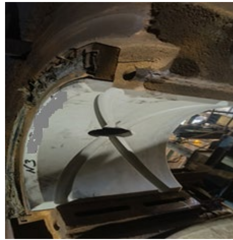
Рис. 2. Зовнішній вигляд розташування вкладишів з тимлон-7: а) № 2 з приводної сторони; б) № 3 з холостої сторони
